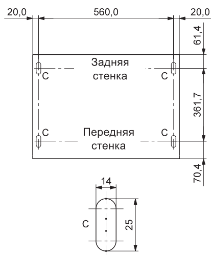
Рис. 56 Шаблон для сверления под подставку (мм)
